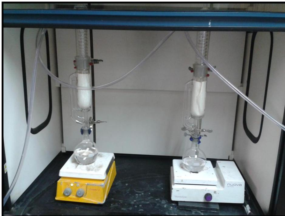
**Figura 3.5. Sistema de Extracción Soxhlet**
