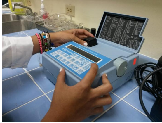
Figura 5.9 Espectrofotómetro para la medición de Sólidos Suspendidos.
