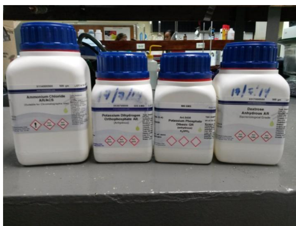
Figura 5.3. Reactivos que componen el agua residual artificial.
