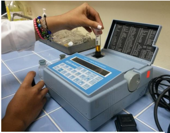
Figura 5.10. Muestras de DQO, colocadas en el digestor
