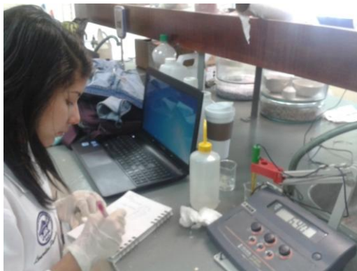
Figura 5.6. Medición del pH de las muestras del efluente, reactor y la salida, con un pHmetro.
