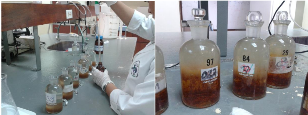
Figura 5.12. Pruebas de DBO 5 .
